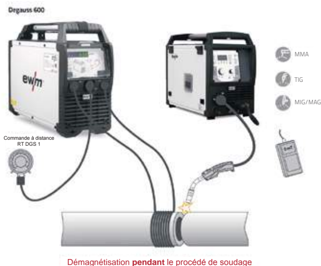
Fig. 8 Représentation schématique : Génération d'un champ magnétique opposé pendant le soudage
